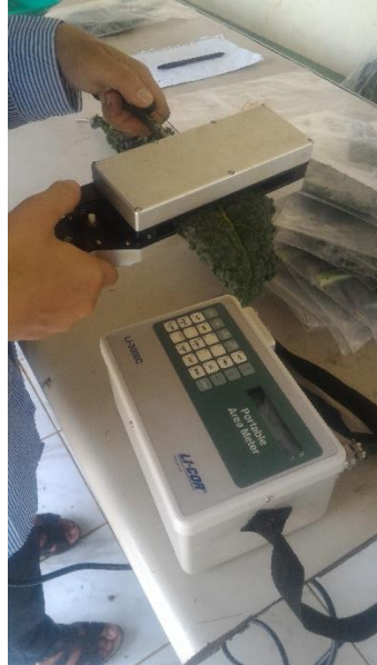
Gambar 2. Pengukuran Luas Daun dengan LI-3000c
