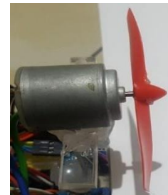
Gambar 2.2 Baling-baling kipas L9110 Fan Propeller Motor Module dan Motor DC
